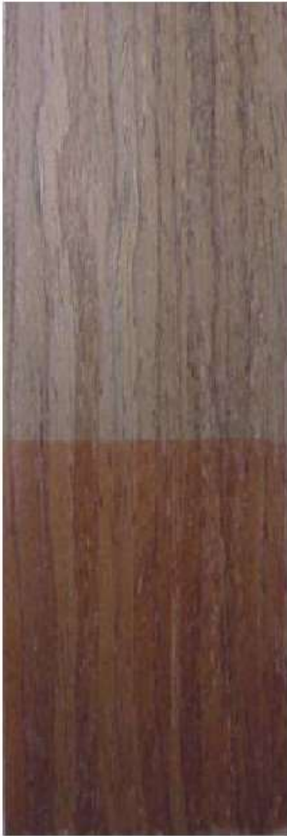
Slika 4.4 Testni primjerak nakon testa otpornosti na svjetlost
