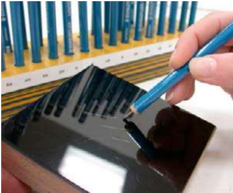
Slika 4.2 Ispitivanje tvrdoće pomoću olovki
